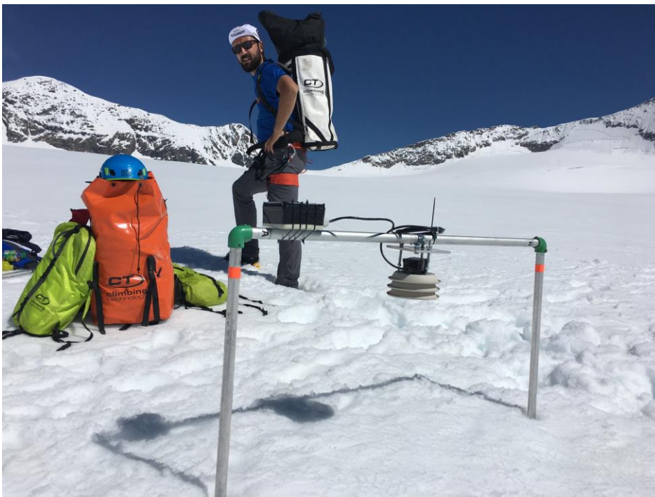
Fig. 10. Installazione dell'Ablatometro digitale per misurare la fusione estiva della neve a 3500 m s.l.m.
